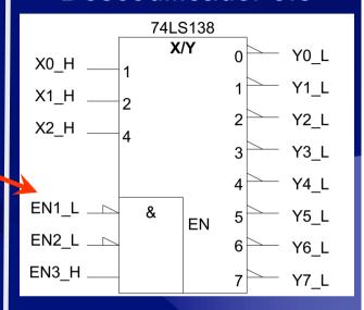
Descodificador 3:8 com saídas activas a LOW (construído a partir de
